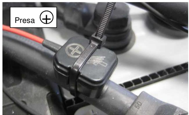
Collegando la presa sul polo positivo della batteria lo **SPY-BATT** viene alimentato. Il dispositivo presenta in sequenza le seguenti segnalazioni:
